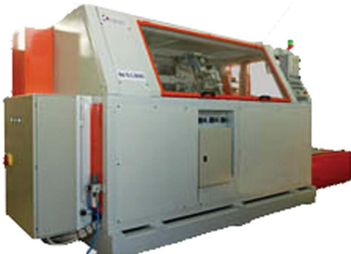
Macchina semi-automatica per il taglio di tubi di cartone.
